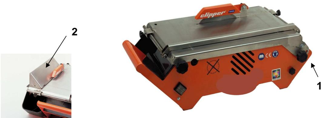
Die Führung für abgeschrägte Schnitte ist hinter der Maschine gelagert.
